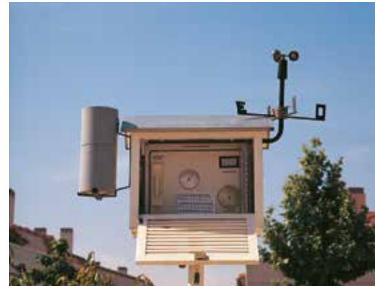
Estación meteorológica e instrumental de registro: pluviómetro, barómetro y termómetro, entre otros.
