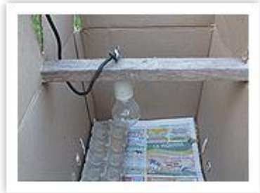
Instalamos el portalampara sobre el travesaño.
